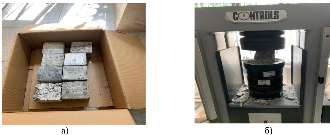
а – выдерживание образцов цементобетона в солевом растворе; б – испытания образцов цементобетона после выдержки в солевом растворе на прессе
