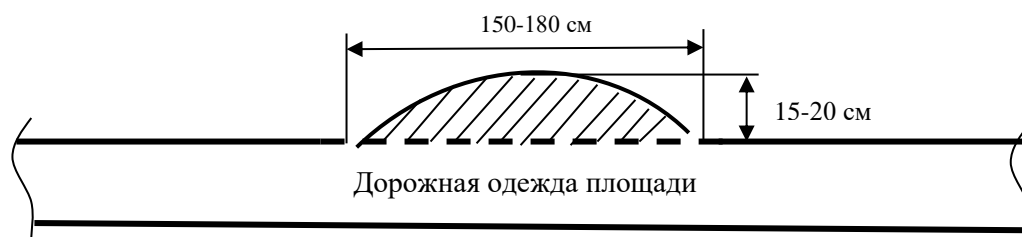
Рисунок 4.9 – Устройство въезда на открытую площадку
