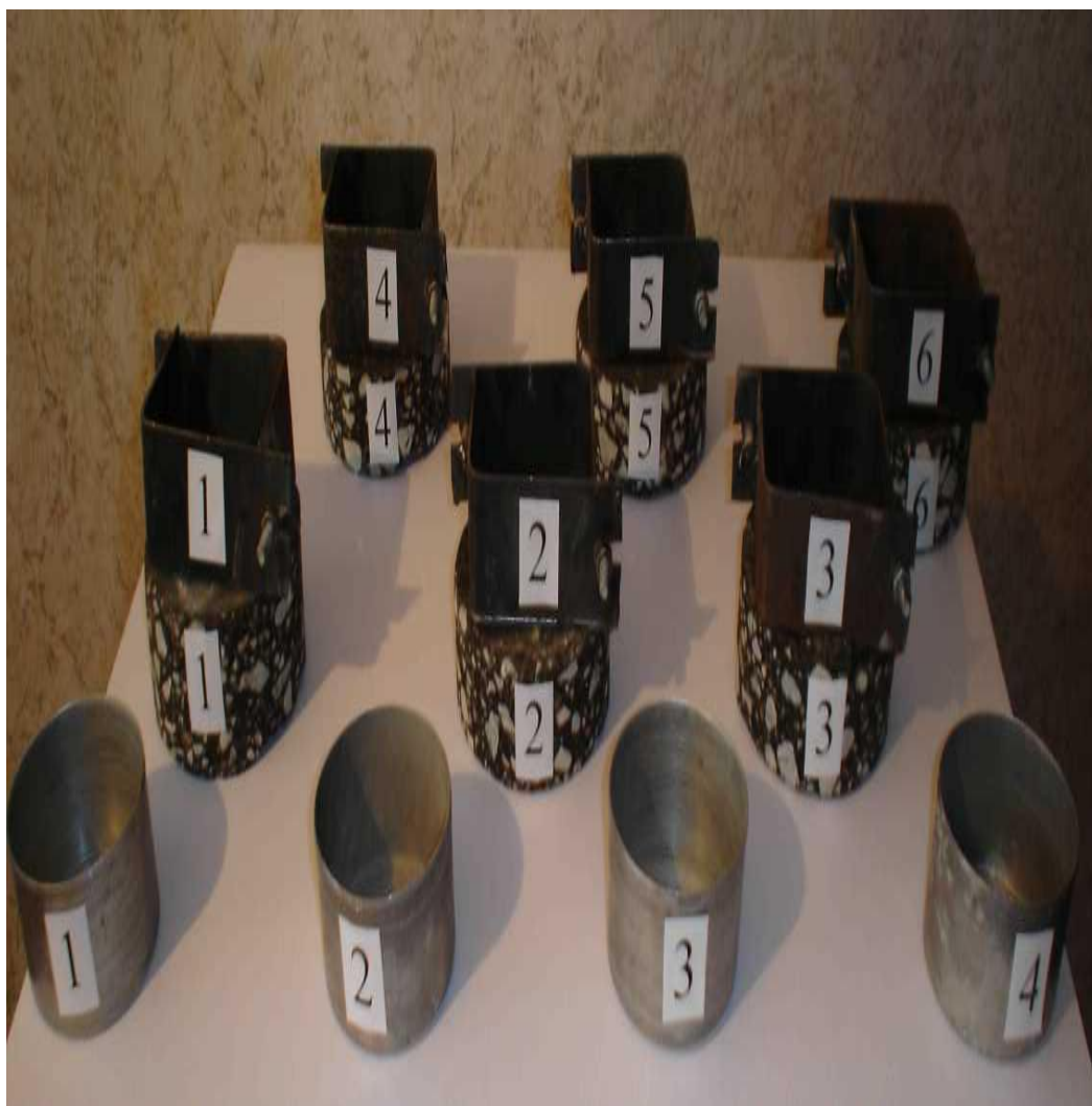
Рисунок 3.7 – Цементобетонные образцы и крепления для замораживания льда над поверхность цементобетонного образца (сделать новое фото)
