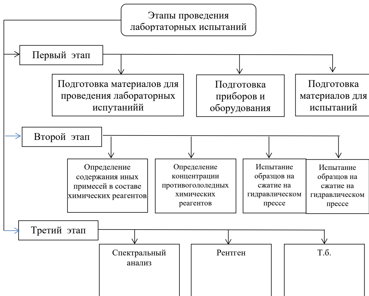
Рисунок 3.1 – Этапы проведения лабораторных испытаний антигололедных химических реагентов
