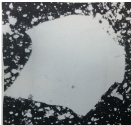
Рисунок 2.2 - Фотография частично гидратированного зерна шлакового стекла, твердеющего один месяц
