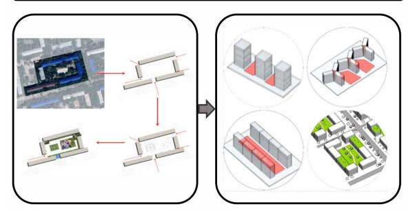
Рисунок Г.7 – Примеры преобразования дворового пространства с использованием принципов концепции: «защищающего пространства»
