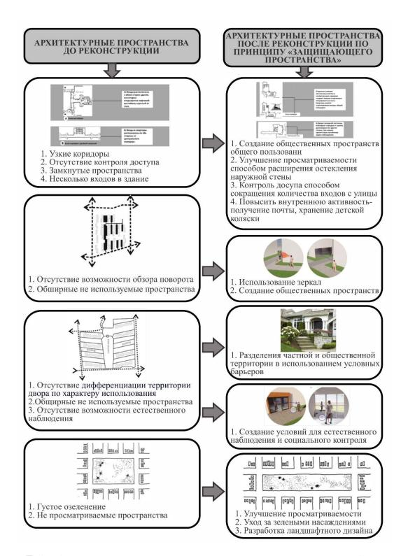
Рисунок Б.5 – Архитектурно-планировочные решения архитектурной среды с использованием принципов концепции «Защищающего пространства»
