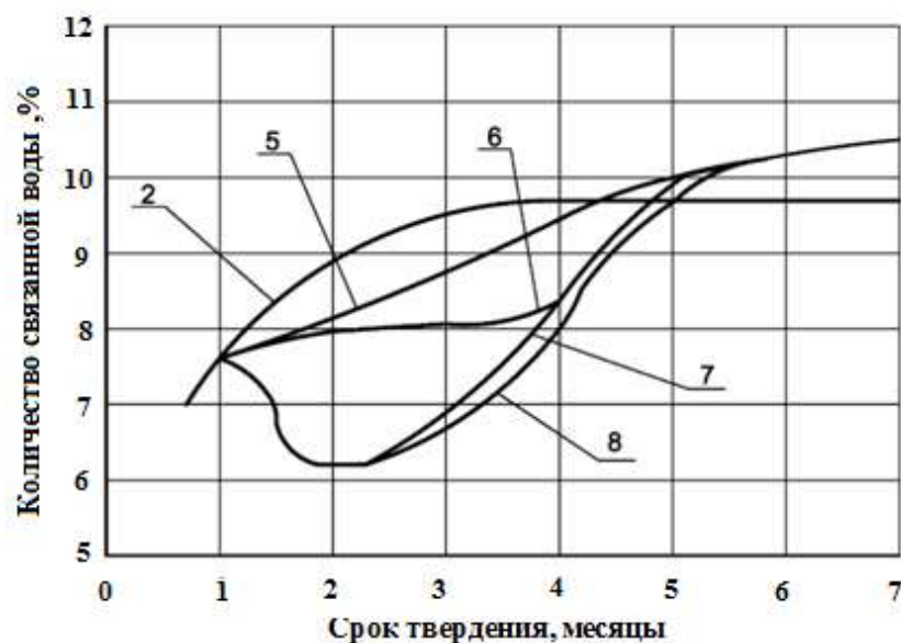
Рисунок 2.11 – Кинетика изменения количества прочносвязанной воды в белитовом цементном камне в процессе твердения при различных температурах
