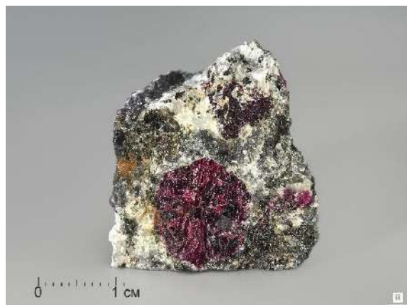
Рисунок 3 – Гнейс – метаморфическая горная порода, состоящая из кварца, калиевого полевого шпата и плагиоклаза.
