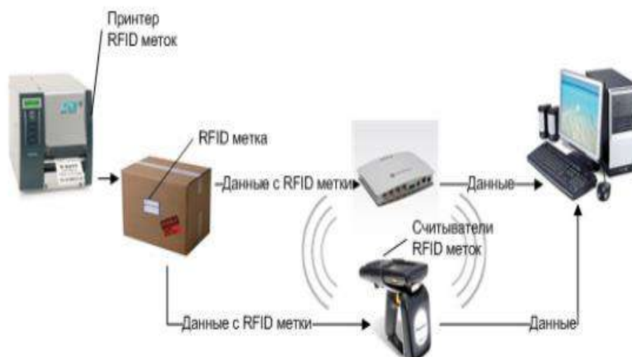
Рисунок 1 – Этапы работы RFID-системы
