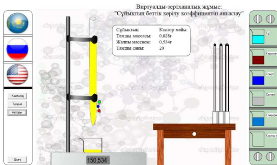
2-сурет – «Сұйықтың беттік керілу коэффициентін анықтау» виртуалды зерханалық жұмыстың электронды моделі
