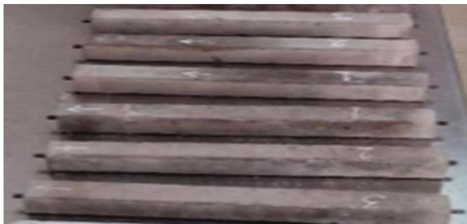
Рисунок 27 – Контрольные образцы размерами 25x25x254 мм с реперами
