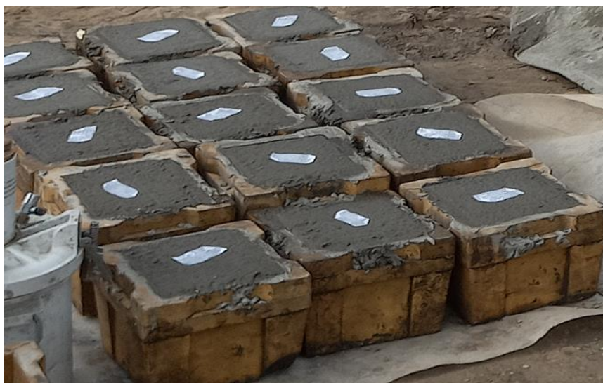
Рисунок 4 – Твердение контрольных образцов бетона размерами 150x150x150 мм
