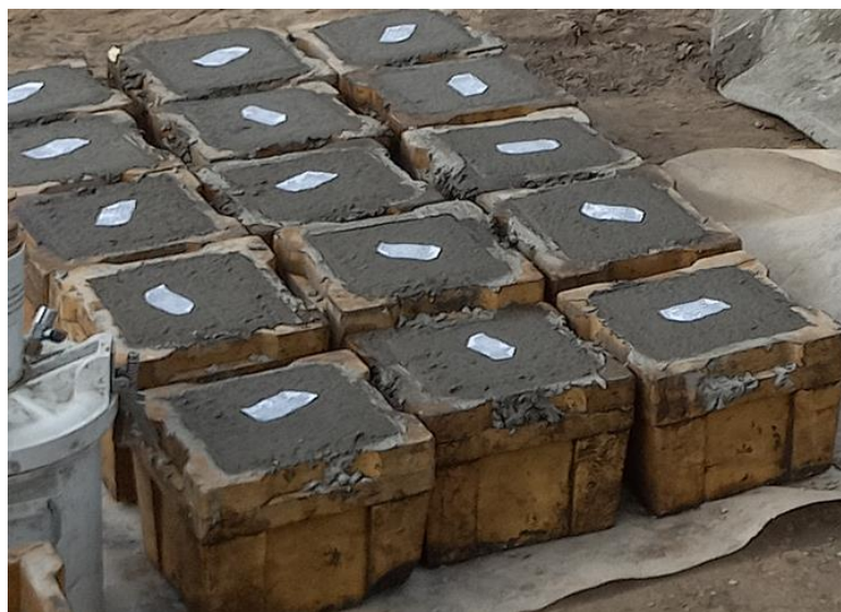
Рисунок 4 – Твердение контрольных образцов бетона размерами 150x150x150 мм
