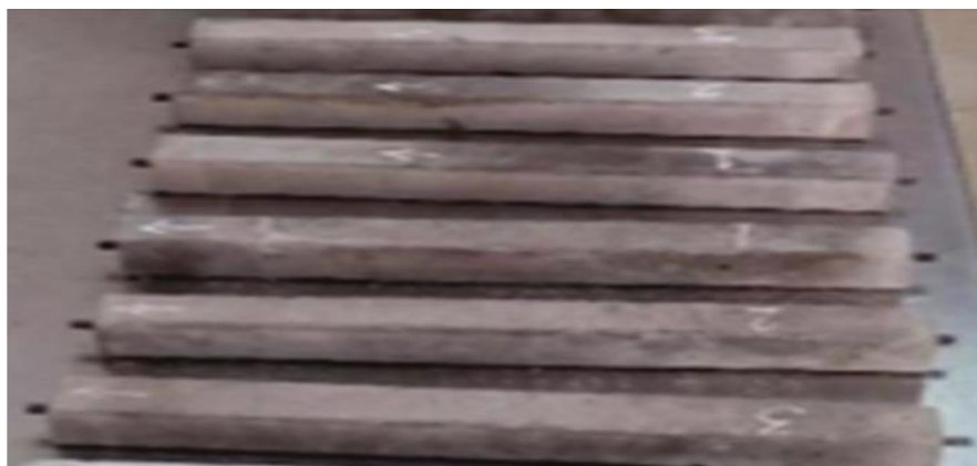
Рисунок 27 – Контрольные образцы размерами 25x25x254 мм с реперами
