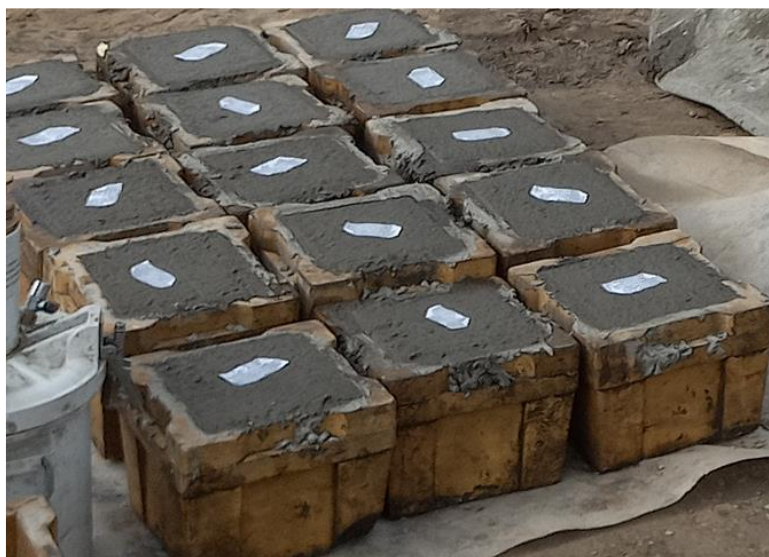
Рисунок 4 – Твердение контрольных образцов бетона размерами 150x150x150 мм
