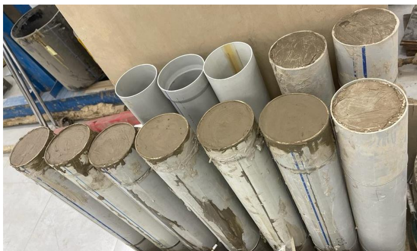
Рисунок 3.13 – а) сформированный образец модели DSM, б) процесс формирования образца в трубе ПВХ
