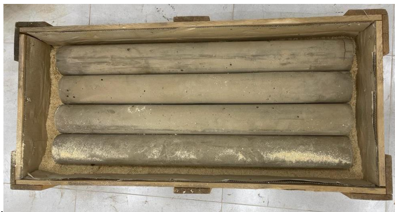
Рисунок 3.12 – хранение образцов DSM
