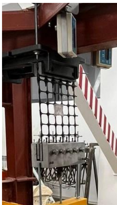
Рисунок Д.3 – Испытание геосетки гексагональной ТХ-170
