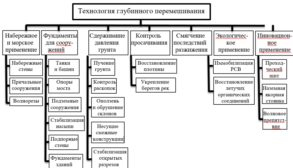
Рисунок 1.10 – Области применения технологии DSM
