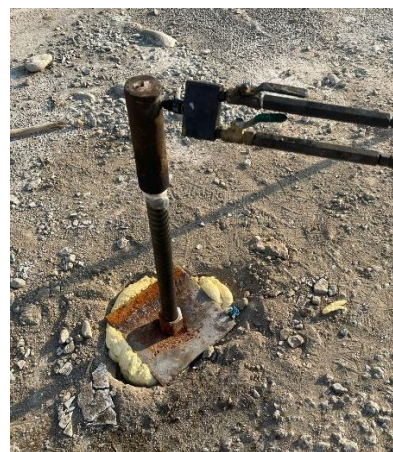
Рисунок 2.15 – а) вид винтового анкера, б) герметизация анкера при полевых испытаниях
