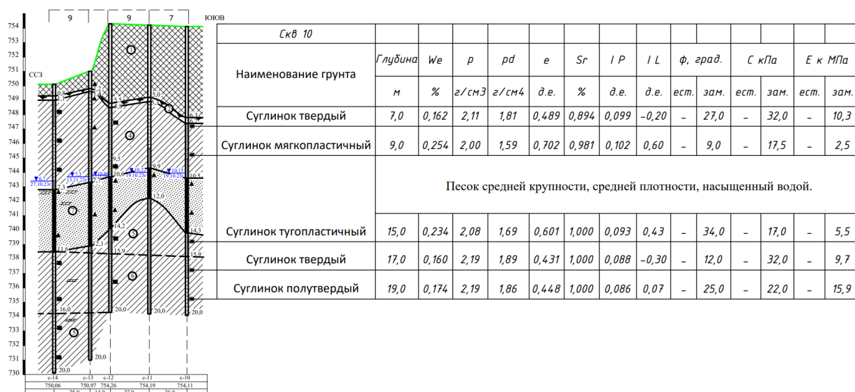
Рисунок 5.3 – Геологический разрез по скв.10 и свойства грунтов основания.
