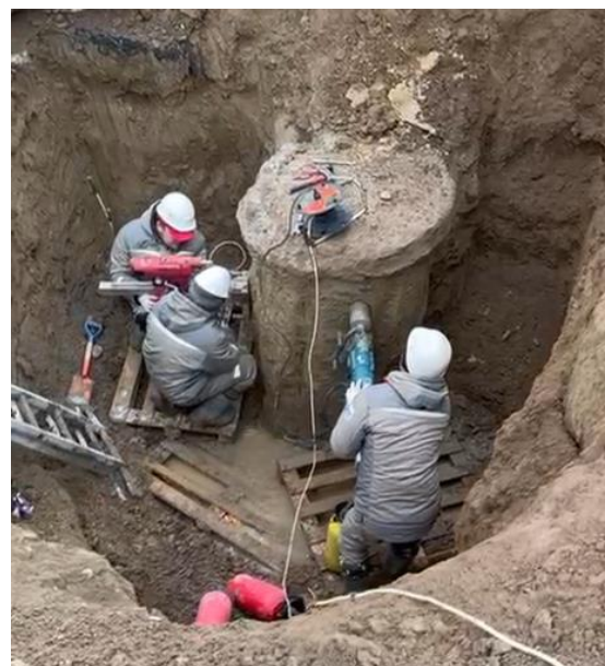
Рисунок 3.2 – Отбор образцов из опытных свай
