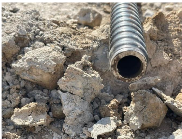
Рисунок 2.15 – а) вид винтового анкера, б) герметизация анкера при полевых испытаниях
