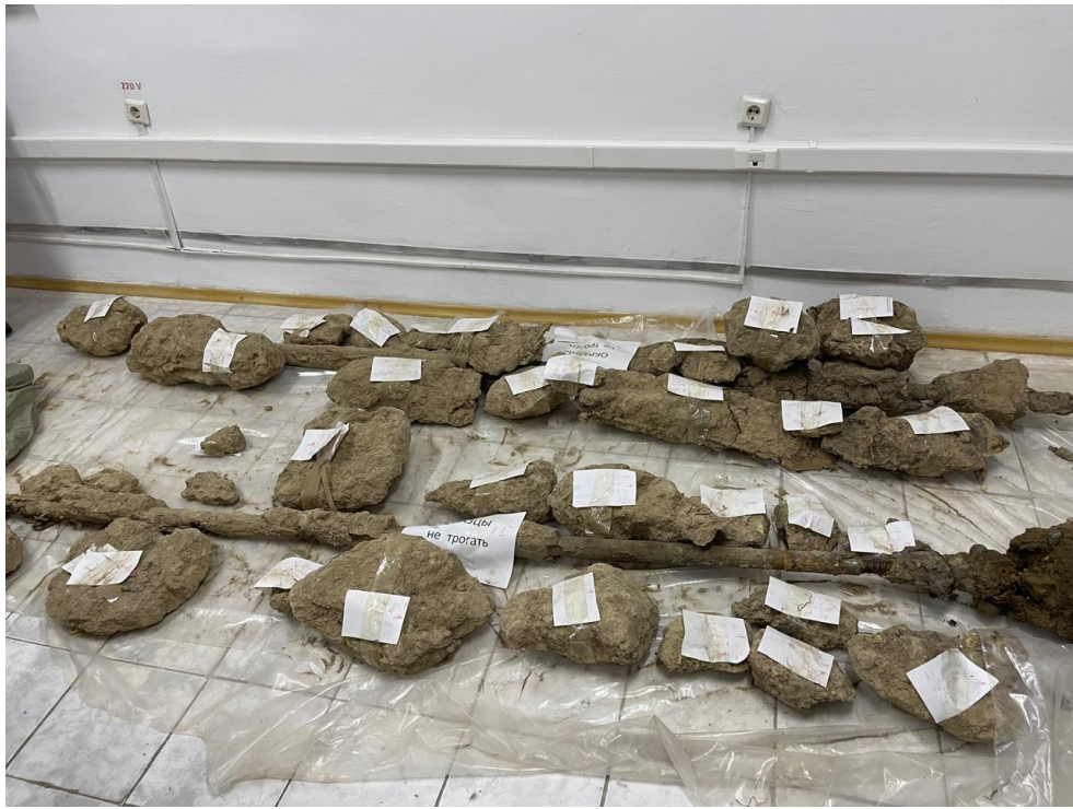
Рисунок В.3 – Вид извлечённых анкеров с полевых испытаний
