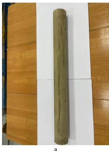
Рисунок 3.13 – а) сформированный образец модели DSM, б) процесс формирования образца в трубе ПВХ
