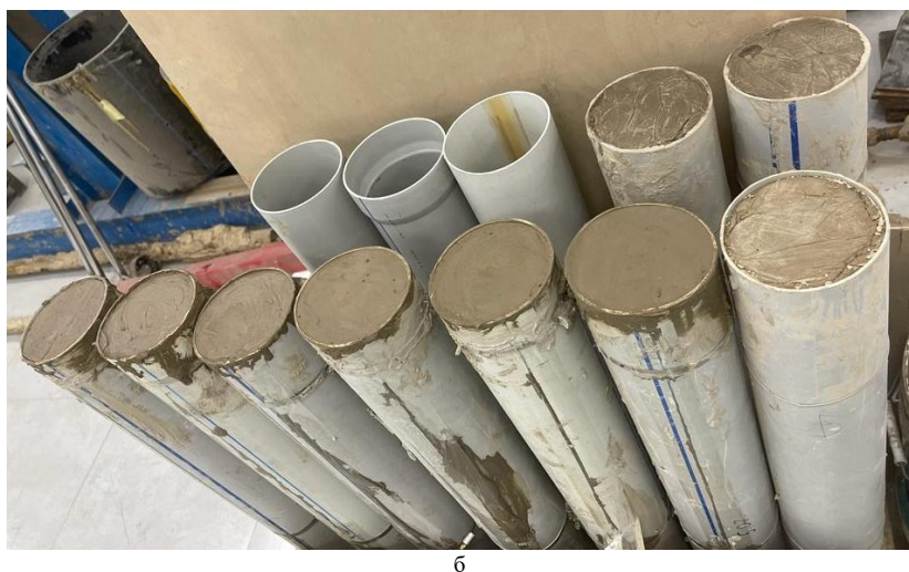
Рисунок 3.13 – а) сформированный образец модели DSM, б) процесс формирования образца в трубе ПВХ
