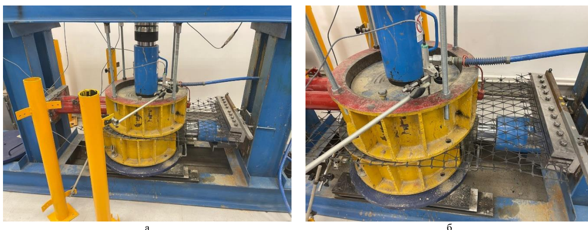
а - общий вид сдвигового прибора; б - устройство для фиксации геосинтетика
