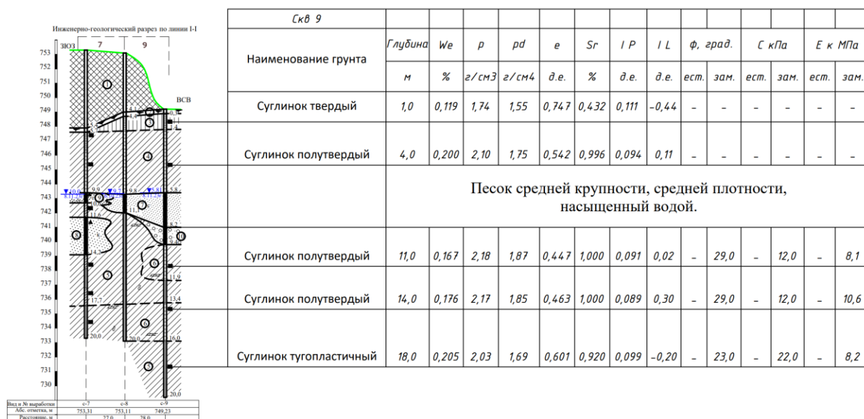
Рисунок 5.2 – Геологический разрез по скв.9 и свойства грунтов основания
