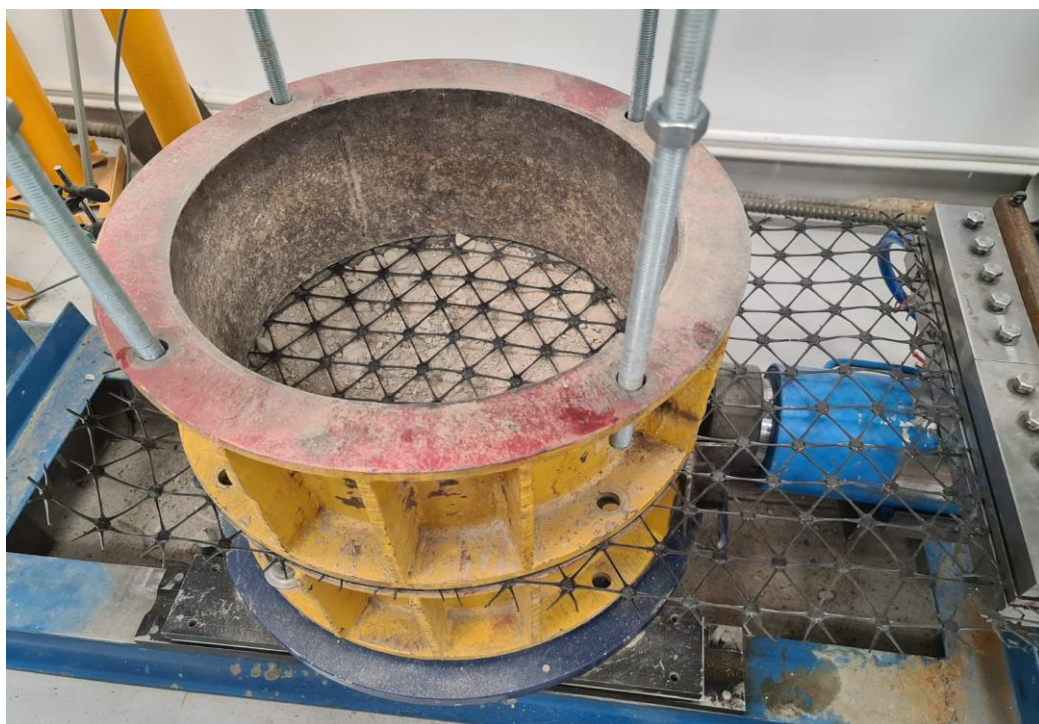
Рисунок Д.6 – Подготовка к лабораторному испытанию на сдвиговом приборе
