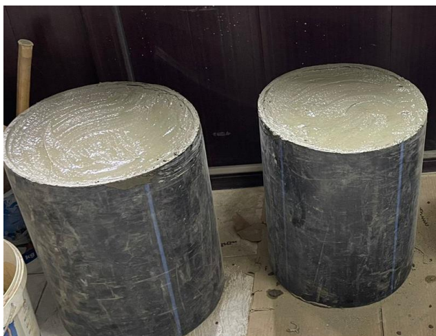
Рисунок 2.12 – Вид трубы с образцом при испытаниях гравийного грунта
