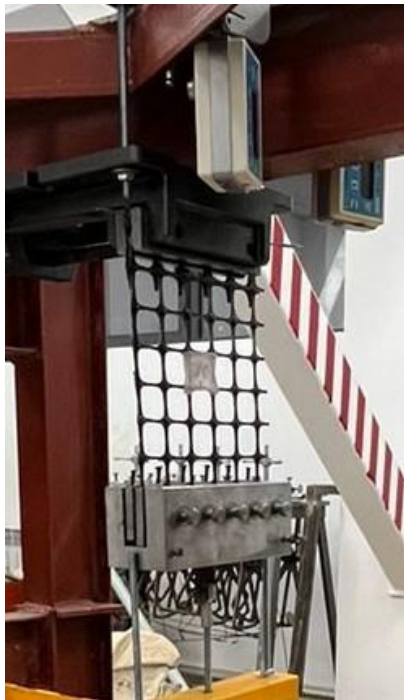
Рисунок Д.3 – Испытание геосетки гексагональной ТХ-170
