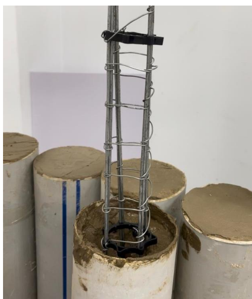
Рисунок 3.16 – процесс погружения арматурного каркаса
