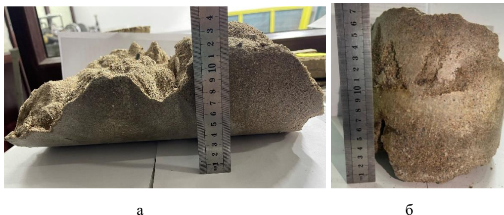
Рисунок 2.5 – Пример закрепления песчаного грунта с использованием двухкомпонентной смолы в лабораторных условиях
